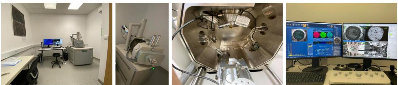
*Slika 4. Mikroskop ESEM Quanta 650.*
